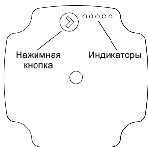
Рис. 17 Интерфейс пользователя с одной кнопкой и пятью светодиодами.
